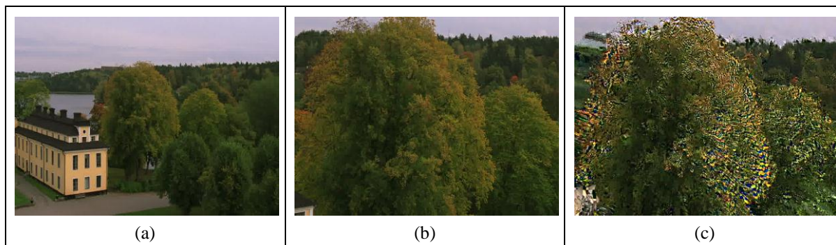
Figura 12. Exemplo de frame do vídeo ( frame de número 115) recebido pelo host H2 conforme as condições normais da rede (a), com atraso de 90ms e jitter de 45ms (b) e com atraso de 100ms e jitter de 50ms (c).
